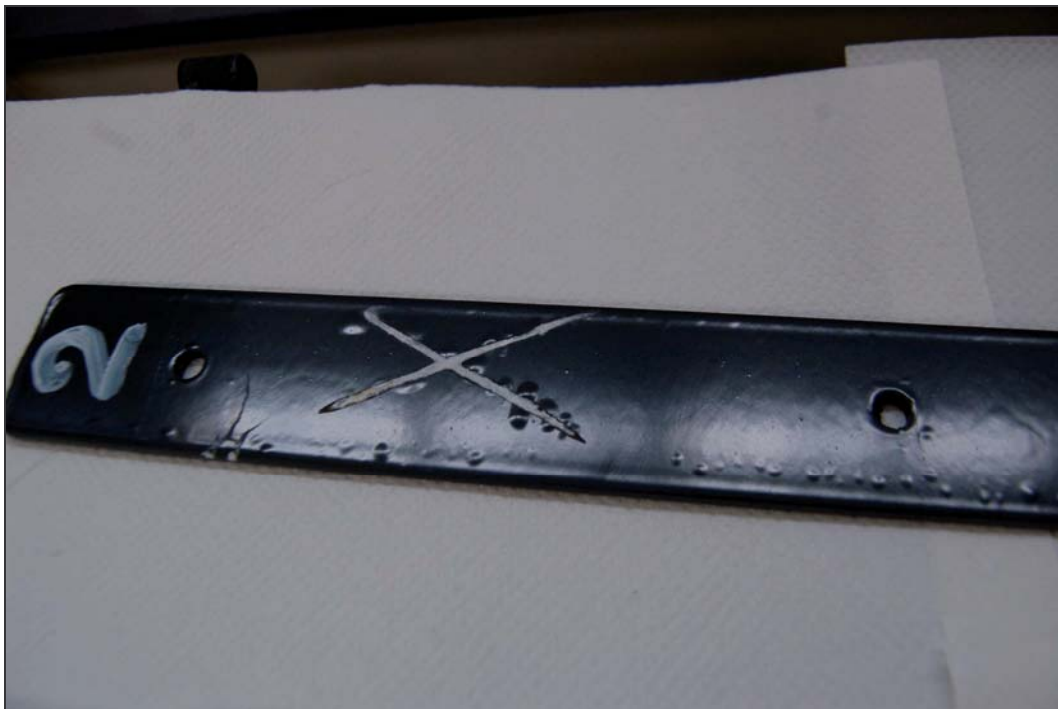
Foto campione 2 dopo 400 ore di nebbia salino acetica.
