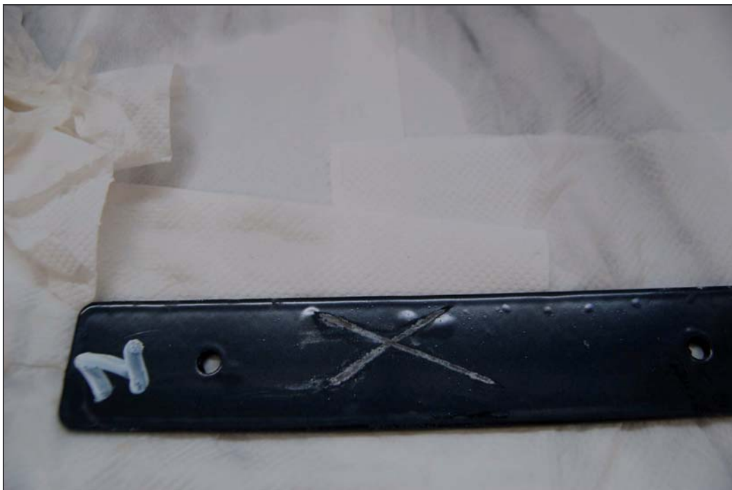
Foto campione 1 dopo 400 ore di nebbia salina.
