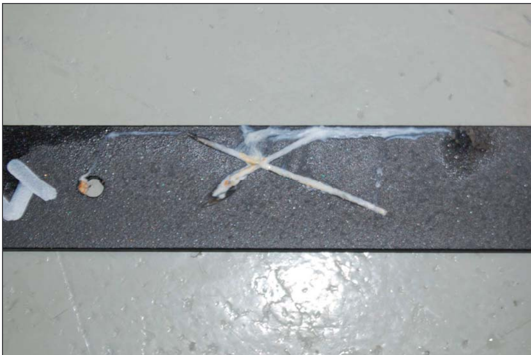
Foto campione 4 dopo 1000 ore di nebbia salino acetica.
