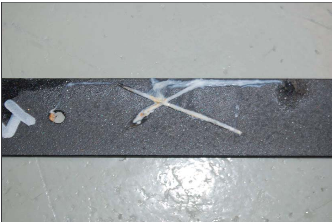
Foto campione 4 dopo 1000 ore di nebbia salino acetica.
